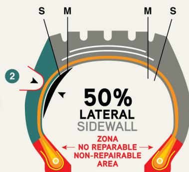
**TABLA PARA REPARACIÓN DE DAÑOS LATERALES (REFUERZO) HASTA EL 50% DE LAS LONAS REALES**
